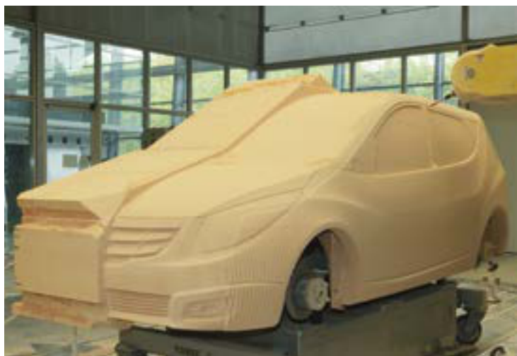
Plně rozměrový automobilový designový model vyrobený ze SikaBlock® M330 desek a lepený s lepidlem Biresin® Kleber Orange
