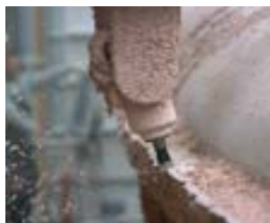
Biresin® M72 pasta lze jednoduše frézovat s nízkou prašností.
