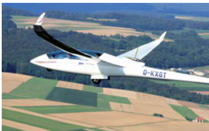
Motorový kluzák vyráběný společností Schempp-Hirth pomocí Biresin® CR122
