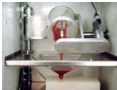
Proces vakuového lití poskytuje díly s nejlepším vzhledem a s nejlepšími mechanickými vlastnostmi.
