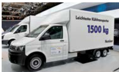
Lehký Transporter s podvozkem a přepravní nástavbou z lehkého carbonu
