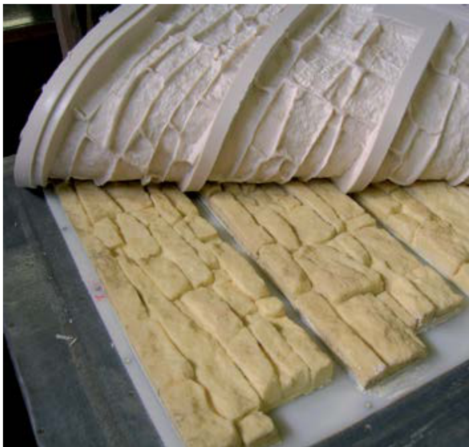
Odformování UR 58480 pružné formy pro kamenné obklady
