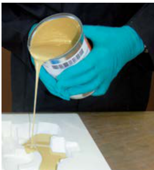
F160-1 s přidaným plnivem pro odlévání modelů s tlustšími sekcemi
