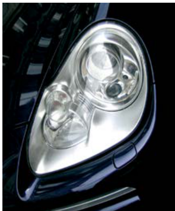
Prekryt předních světel vyrobený z materiálu PX 5212
