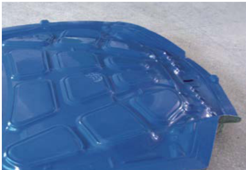
Nástroj pro vyztužení kapoty vyrobený z GC1 080
