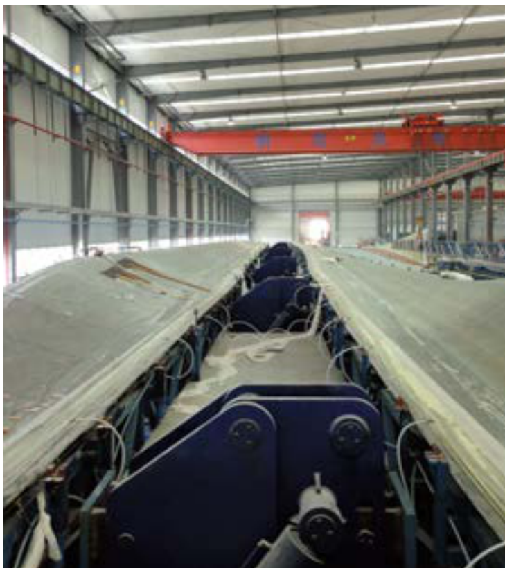
Vakuová infuze větrné lopatky pomocí Biresin® CR131
